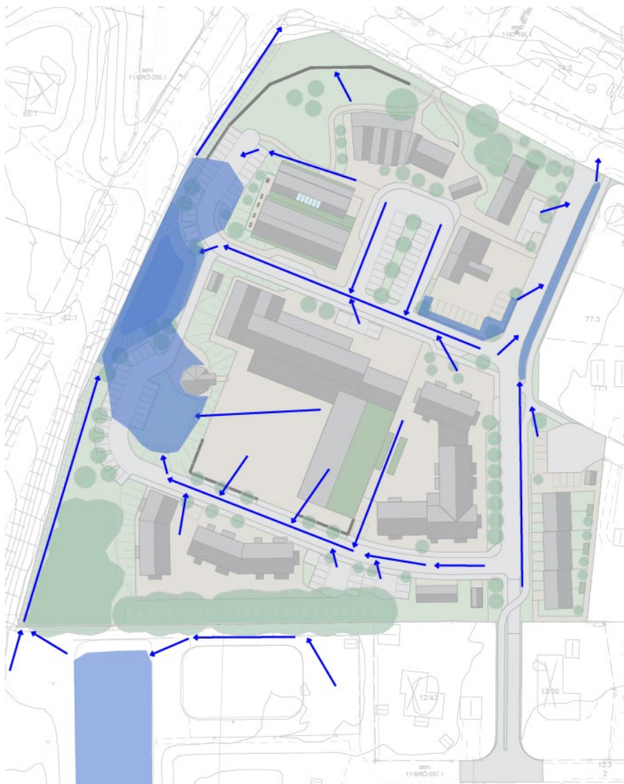
Möjliga sekundära avrinningsvägar för skyfall illustrerade med blå pilar och översvämningsytor markerad med blått.
