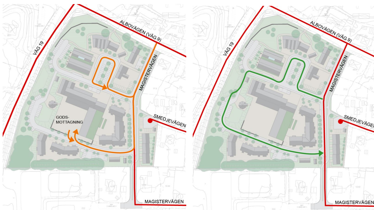
Till vänster: Föreslagen körväg för godstrafik markerad med orange linje. Till höger: Föreslagen körväg för sopbil samt underhåll- och servicefordon inom kvartersmark markerad med grön linje.
