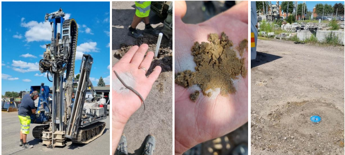
Bild 4.1 – 4.4: Bilderna visar provtagning inom undersökningsområdet. Mellersta bilderna visar skruvprov med såväl rullbar lera (fältindikation på lerförekomst) och sand från samma borrhänder. Grundvattenrör installerades och där dessa finns inom köryta kapades rören nedan markytan och försågs med ett mindre brunnslöck, en så kallad dexell.
