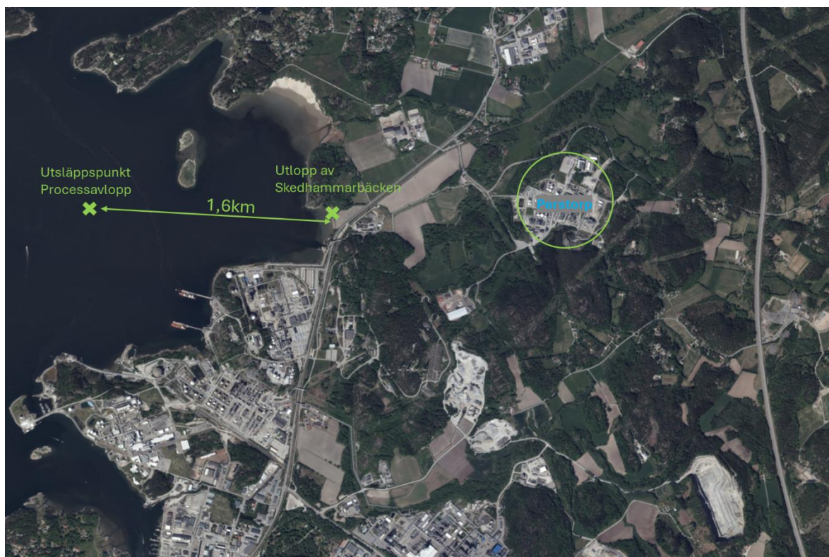
Figur C8. Utsläppspunkt för Perstorp OXO ABs processavlopp och Strävlidens reningsverk i Askeröfjorden. Ledningen är 1610m lång. Utsläppspunkten ligger på 15 m djup. Utsläpp av kylvatten från spärrdammen går via Skedhammarsbäcken till den grunda viken.
