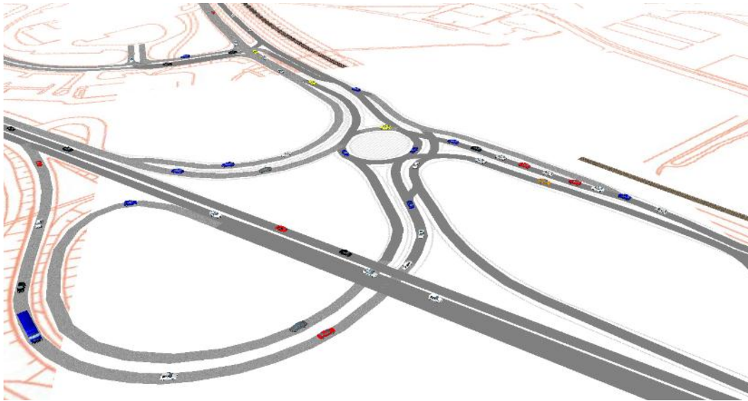
Figur 15. Vid en trafiksimulering av en hårt belastad maxtimme på morgonen i Nösnäsmotet utformat enligt förslag 4 kan man se att köerna med trafik från Hallernaområdet inte kommer att växa sig lika långa som med dagens utformning, jämför med figur 5.
