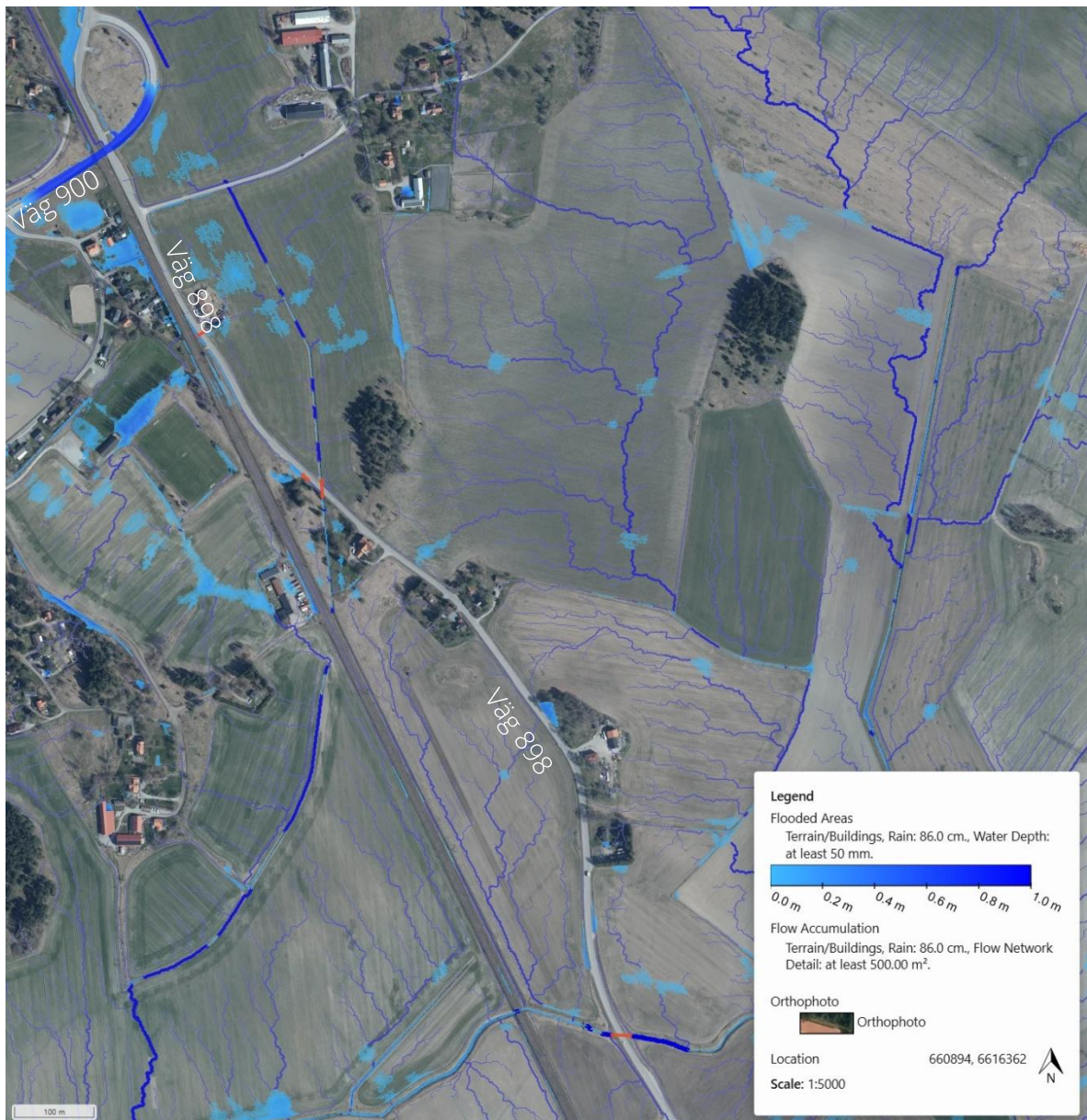
Figur 8. Befintlig skyfallssituation enligt lågpunktskartering i Scalgo Live. Bakgrundskarta från Lantmäteriet. Befintliga trummor markerade med orange linje.
