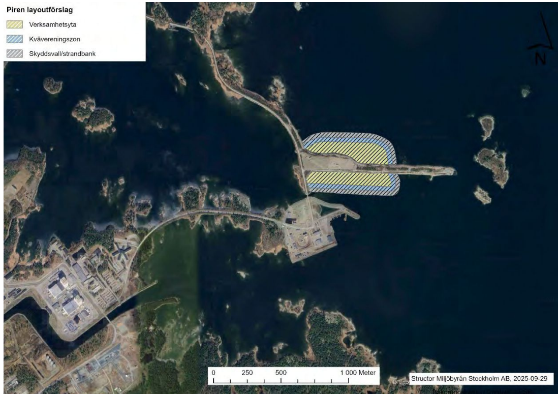
Figur 3 Den planerade verksamheten omfattar utvidgning av befintlig pir genom utfyllnad i Öregrundsgrepen. Syftet med åtgärden är att till skapa nödvändiga verksamhetsytor för SKB:s anläggningsprojekt kopplat till utbyggnaden av Kärnbränsleförvaret och SFR, samt andra åtgärder som kan behövas för att minimera verksamhetens omgivningspåverkan. (Karta från Stuctor 2025-02-18).
