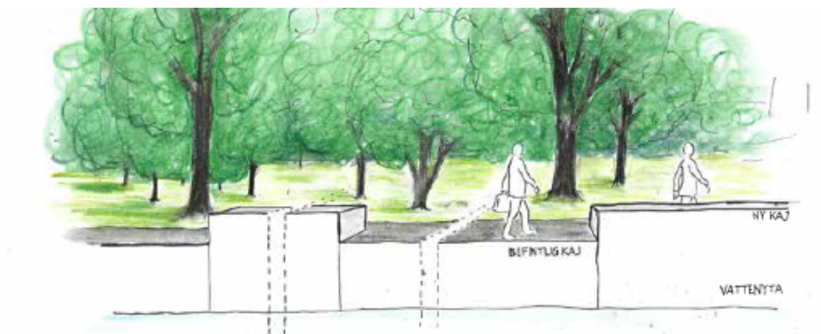
Illustration längdsektion/elevation ny kaj med uppdelad kajbalk
