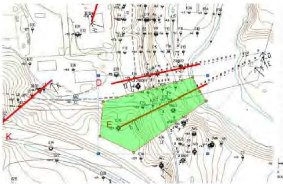
Figur 28. Område som behöver förstärkas (sektion E), enligt fördjupad geoteknisk utredning, daterad 2026-01-08.
