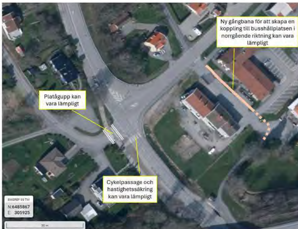
Figur 22. Åtgärdsförslag vid Strömstadvägen
