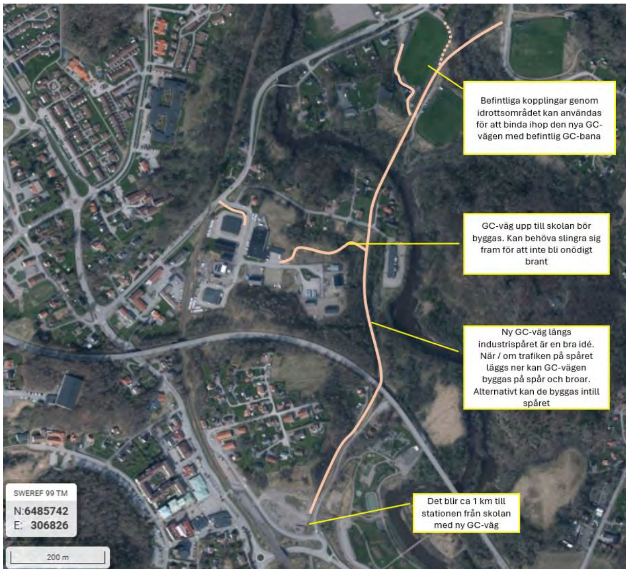
Figur 18. Illustration över det befintliga gång- och cykelvägnätet som studerats, samt möjlig vägsträckning för nya gång- och cykelvägar intill befintlig lokal järnväg.
