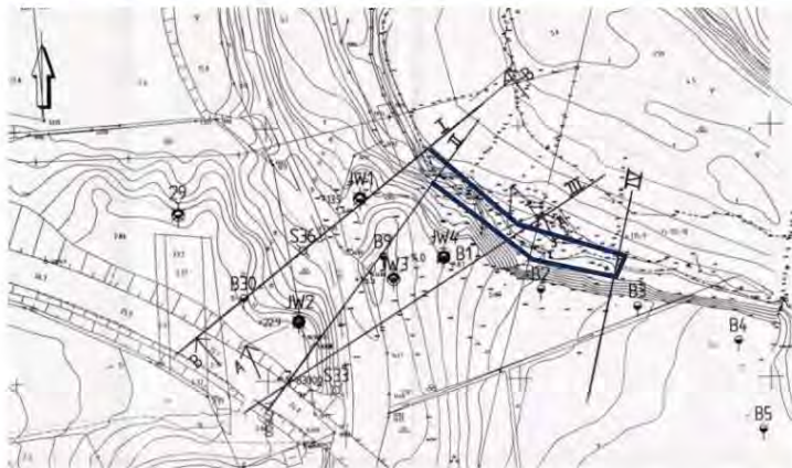
Figur 5. Vägverkets redovisning av beräkningssektioner. Blå markering visar ungefär var förstärkning utförts.
