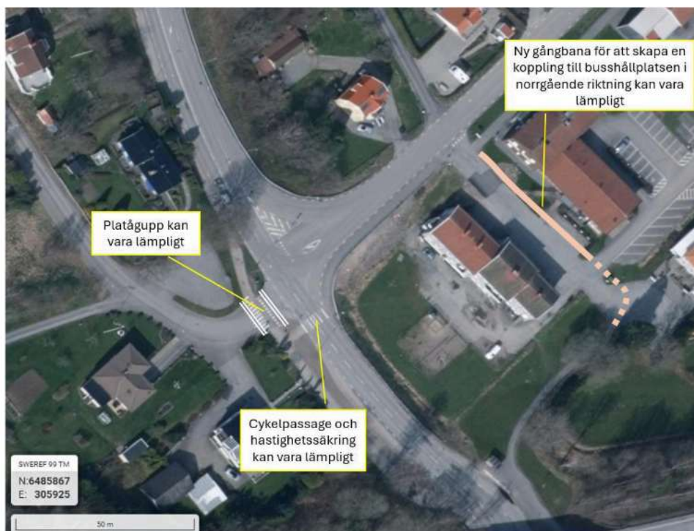
Figur 22. Åtgärdsförslag vid Strömstadvägen
