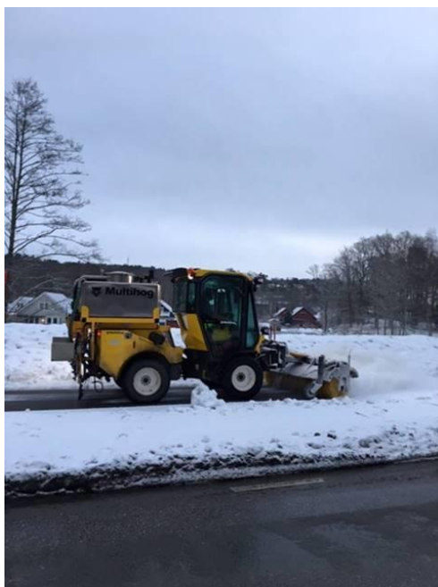
Figur 10: Sopsaltning av en cykelväg.
