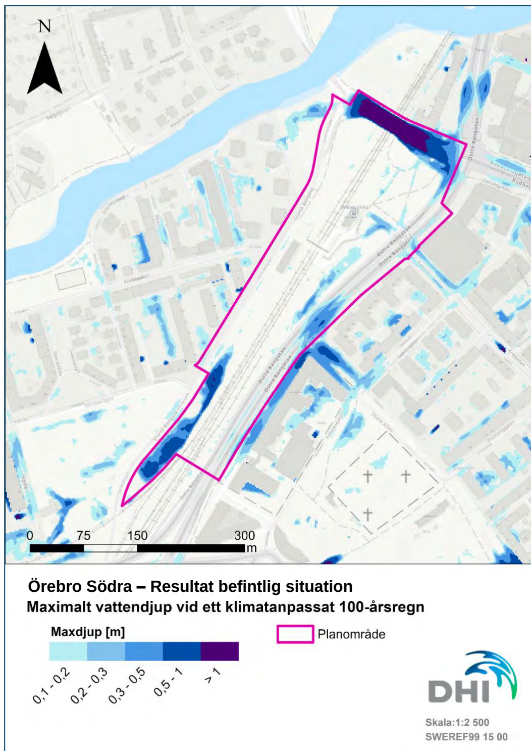
Figur 6-1 Maximalt översvämningsdjup och utbredning vid skyfall motsvarande 100 års återkomsttid, 6 h varaktighet och 1,25 klimatfaktor för nuläge. Antagen ledningsnätscapacitet är 10 år.
