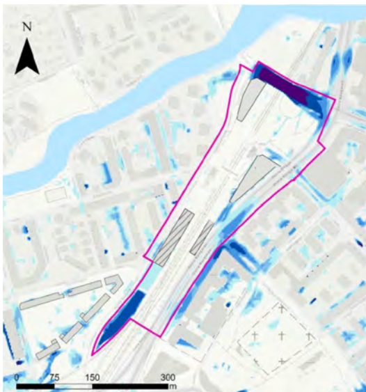
Bilden visar maximalt vattendjup vid klimatanpassat 100-årsregn med föreslagen höjdsättning på Östra Bangatan och torrdamm intill Svartå Bangata. Källa DHI
