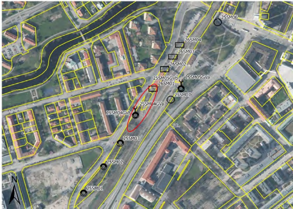
Bilden visar utsnitt från provplan med område markerat i rött där förhöjda halter påvisades vid båda undersökningarna utförda 2017 och 2025. Källa: Structor miljöteknik AB
