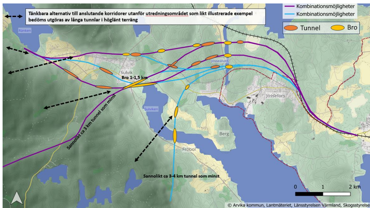
Figur 9: Översiktlig profilbedömning för studerade alternativ i syfte att identifiera avsnitt där det kan uppstå behov av bro och tunnel.
